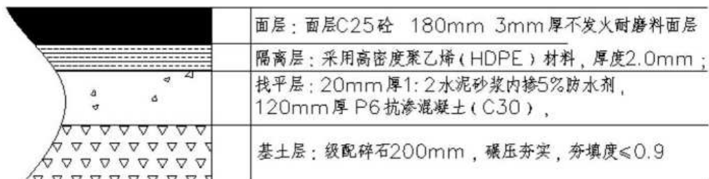
图 6.2-1 重点防渗区域典型防渗结构示意图
